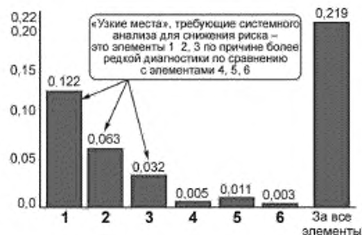
Рисунок Г.7 — Риски нарушения требований по защите информации по элементам 1—6 и за все элементы в течение 2 лет при ежесуточном контроле состояния объектов инженерной инфраструктуры ЦОД
