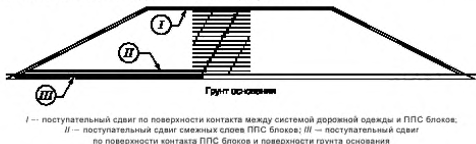
Рисунок 12 — Типовое поперечное сечение насыпи трапецидальной формы с учетом трех видов разрушения
