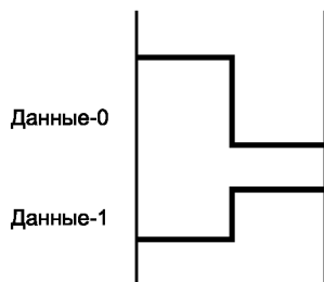
Рисунок 29 — Метод ASK: Основные операции Манчестерского кодирования
