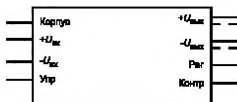
Рисунок Б.1 — Расположение выводов одноканальных СЭМ
