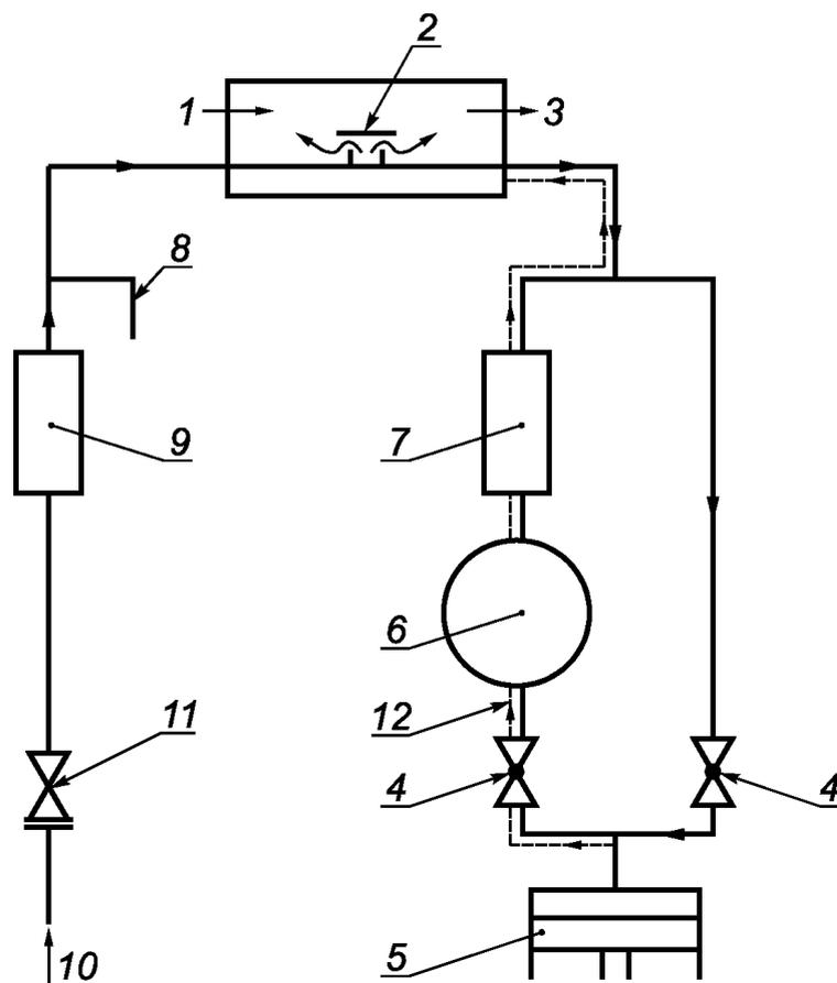
1 — линия подачи тест-вещества; 2 — адаптер для установки испытуемого образца клапана; 3 — сброс; 4 — клапаны управления искусственным легким; 5 — искусственное легкое; 6 — насытитель; 7 — абсорбер; 8 — линия отбора проб подаваемого воздуха; 9 — абсорбер; 10 — линия подачи воздуха; 11 — обратный клапан; 12 — линия отбора проб подаваемой газовой смеси
