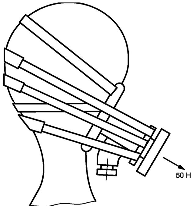
Рисунок 1 — Устройство для испытания соединительного элемента
