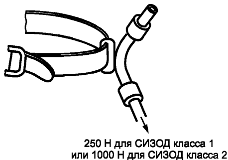
Рисунок 6 — Схема испытания прочности шланга подачи воздуха
