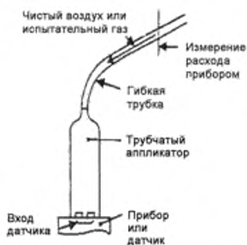
Рисунок В.2 – Примерная схема метода измерения с помощью чистого воздуха или испытательного газа
