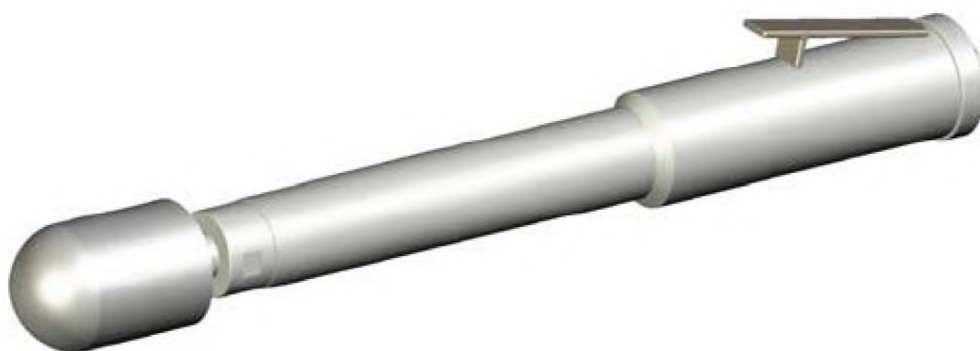
Рисунок 3 — Прямая шлифовальная машина с шлифовальной головкой типа 18R и удлиненной рукояткой
