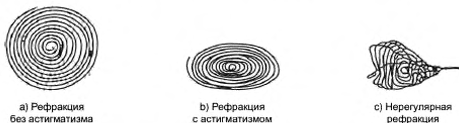
Рисунок 14 — Траектории сканирования светофильтров с различными видами рефракции
