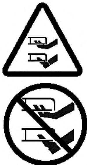
Рисунок АА.4 — Знак безопасности, обозначающий: «ВНИМАНИЕ. Держите руки и ноги на удаленном расстоянии от лезвий. Они продолжают вращаться после выключения двигателя»
