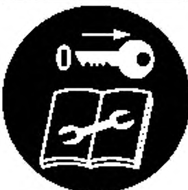
Рисунок АА.6 — Знак безопасности, обозначающий: «ВНИМАНИЕ. Удалите отключающее устройство перед техническим обслуживанием»
