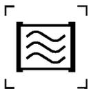
Рисунок 1 — СД-лампа, предназначенная для работы на высокой частоте
