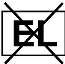
Рисунок 3 — СД-лампа не пригодна для аварийного освещения
