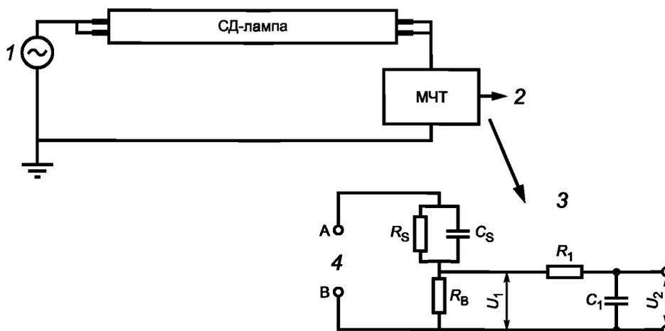
$$R_S = 1500 \text{ Ом}; R_1 = 10000 \text{ Ом}; R_B = 500 \text{ Ом}; C_S = 0,22 \text{ мкФ}; C_1 = 0,022 \text{ мкФ}$$
