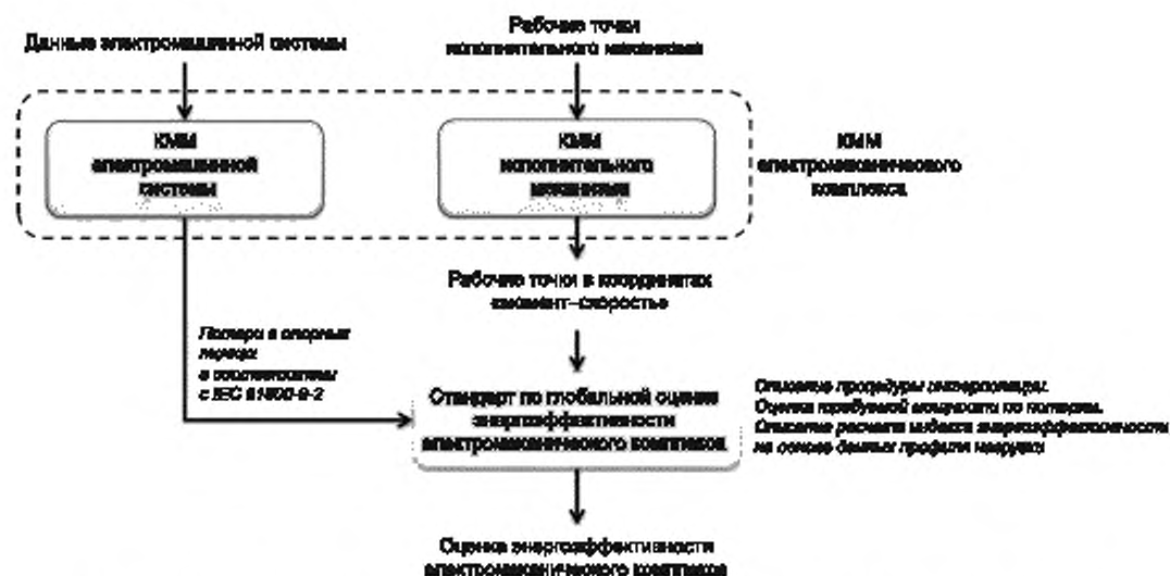
Рисунок 7 — Диаграмма последовательности действий при оценке индекса энергоэффективности электромеханического комплекса
