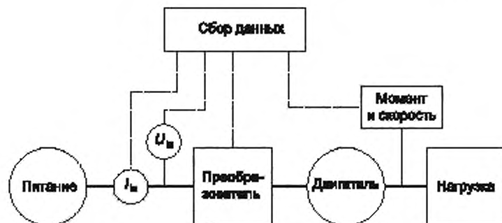
Рисунок 20 — Определение потерь в электроприводе методом вход-выход
