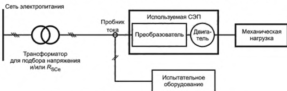
Рисунок В.6 — Испытательная установка с механической нагрузкой
