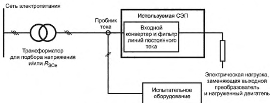
Рисунок В.8 — Испытательная установка с резистивной нагрузкой
