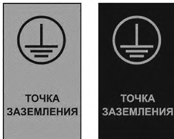
Рисунок 5 — Пример этикетки для МКСМ типа C, обозначающей точку заземления
