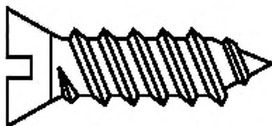
Рисунок 1 — Самонарезающий формующий винт (3.6.10)
