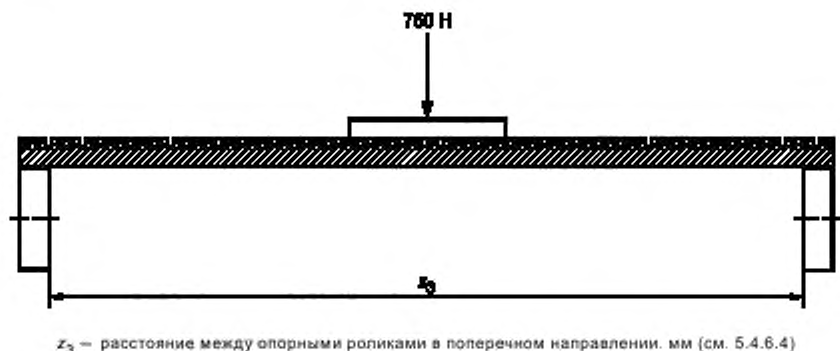
Рисунок 8 — Лента (вид в разрезе), одиночное усилие
