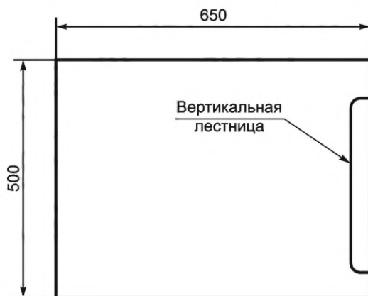
Рисунок 13 — Минимальные размеры свободного проема люка прямоугольного сечения
