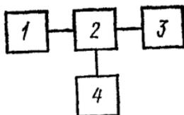
1—источник оптического излучения на основе светодиода; 2—камера с ФЭУ и делителем напряжения; 3—вольтметр или осциллограф; 4—источник питания ФЭУ.
