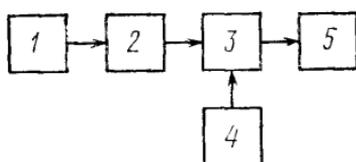
1—источник импульсов оптического излучения; 2—измерительный ослабитель; 3—камера с исследуемым ФЭУ и делителем напряжения питания; 4—источник питания ФЭУ; 5—импульсный вольтметр или осциллограф.
