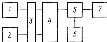
1, 2—источники постоянного оптического излучения; 3—измерительный ослабитель; 4—оптический смеситель; 5—камера с исследуемым ФЭУ, делителем напряжения питания и резистором анодной нагрузки; 6—источник питания ФЭУ; 7—вольтметр постоянного тока.
