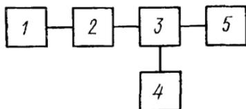
1—стабилизированный источник оптического излучения; 2—измерительный ослабитель; 3—камера с исследуемым ФЭУ и делителем напряжения питания; 4—стабилизированный источник питания ФЭУ; 5—устройство для регистрации значений анодного фототока.
