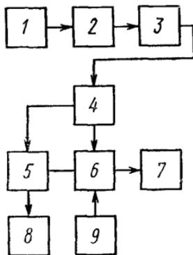
1—блок питания и контроля режима источника излучения; 2—источник излучения; 3—осветительная система; 4—спектральный прибор; 5—контрольный приемник излучения; 6—исследуемый ФЭУ; 7—устройство для измерения выходного сигнала исследуемого ФЭУ; 8—устройство для измерения выходного сигнала контрольного приемника, 9—блок питания ФЭУ.
