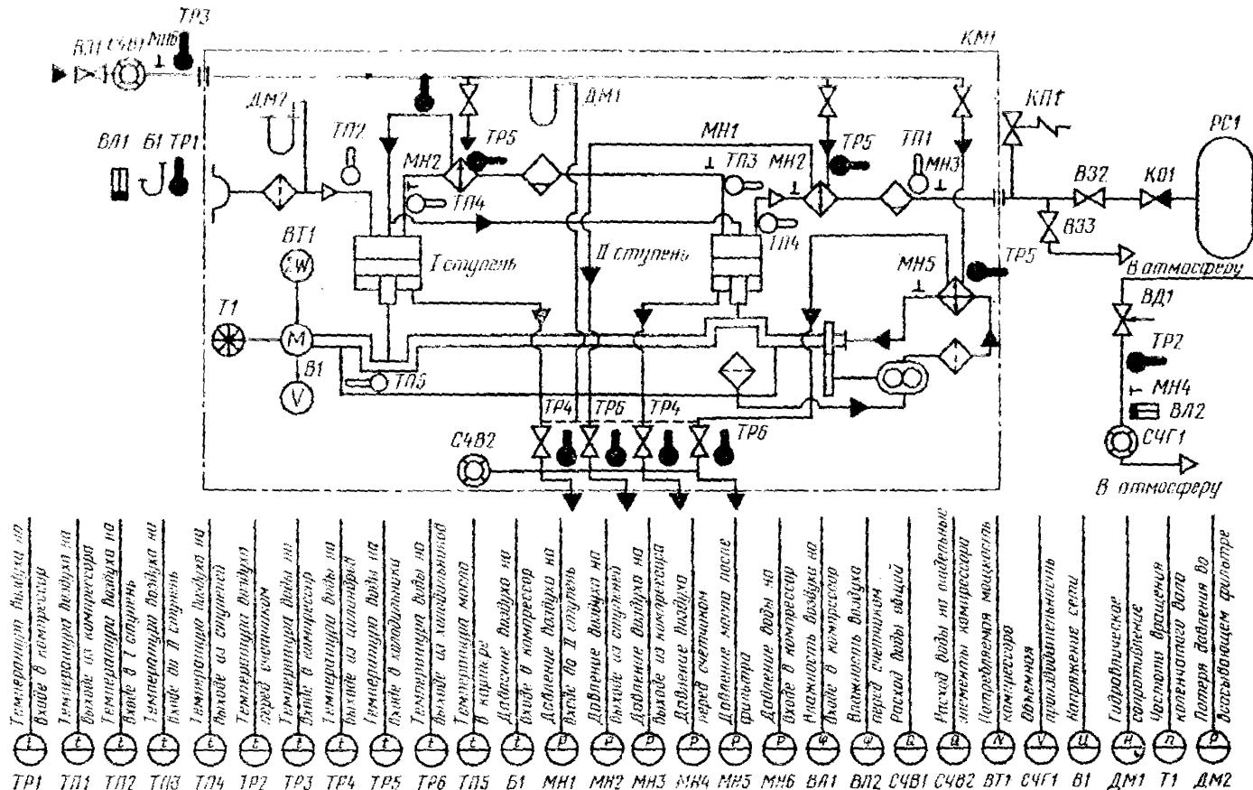
*B1*—барометр; *B1*—вольтметр; *ВД1*—дросселирующий вентиль; *B31*—*B33*—запорные вентили; *ВЛ1*; *ВЛ2*—влагомеры; *BT1*—ваттметр; *ДМ1*, *ДМ2*—дифманометры, *KM1*—компрессор; *KO1*—обратный клапан; *KП1*—предохранительный клапан; *MН1*—*MН6*—манометры; *PC1*—ресивер; *CЧВ1*, *CЧВ2*—счетчики воды; *CЧГ1*—счетчик газа; *T1*—тахометр; *TP1*—*TP5*—термопары; *TP1*—*TP6*—рутные термометры
