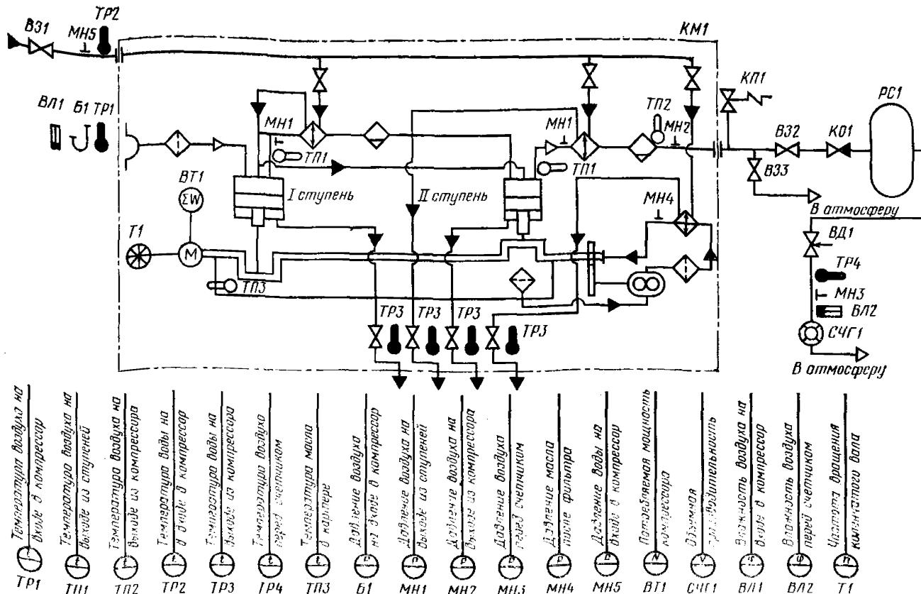
Б1—барометр; ВТ1—ваттметр; ВЛ1, ВЛ2—влагомеры; ВД1—дросселирующий вентиль; В31—В33—запорные вентили; KM1—компрессор; КП1—предохранительный клапан; KO1—обратный клапан; МН1—МН5—манометры; PC1—ресивер; СЧГ1—счетчик газа; Т1—тахометр; ТР1—ТР4—ртутные термометры; ТП1—ТП3—термопары
