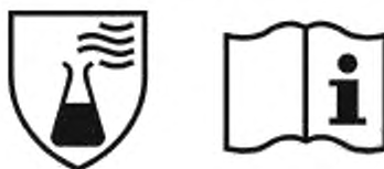
Рисунок 4 — Пиктограмма № 2414, обозначающая защиту от химических веществ, и пиктограмма № 1641 «См. указания по эксплуатации» (см. [9])
