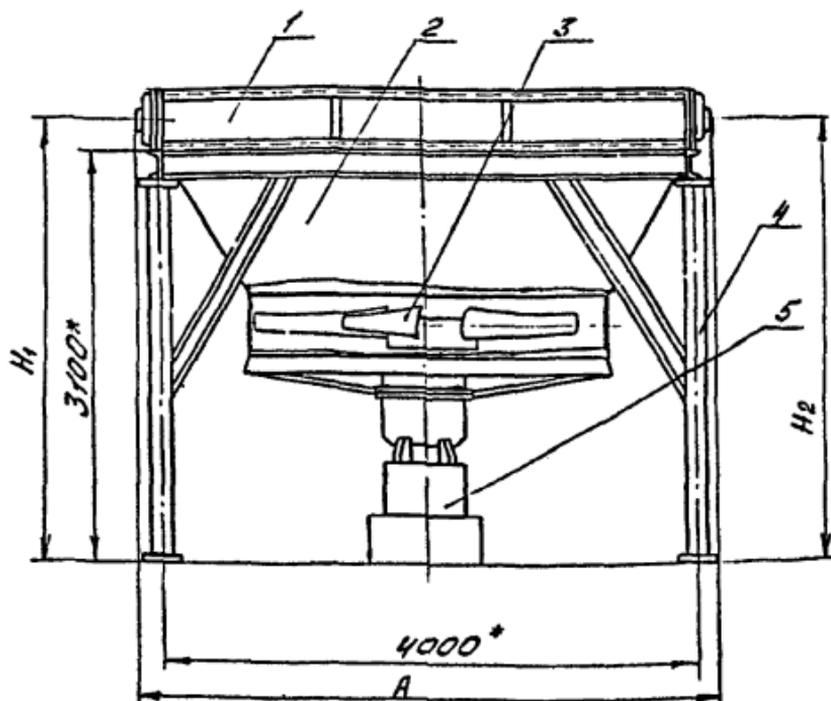
1. Секция 2. Диффузор с коллектором.
