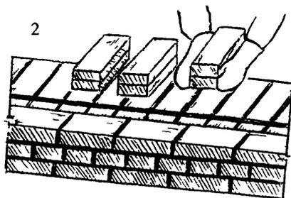
углом  $45^\circ$  к ней стопками по 2 кирпича с расстоянием между ними в один кирпич (поз 1, 3). Для кладки забутки каменщик К-2 раскладывает кирпич перпендикулярно оси стены или под углом  $45^\circ$  к ней стопками по два кирпича с расстоянием между ними в полкирпича (поз 2).
