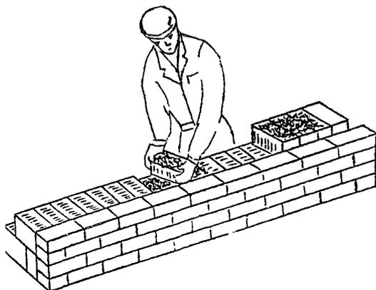
Такой способ укладки называют «вприжим с вытягиванием раствора кельмой».
