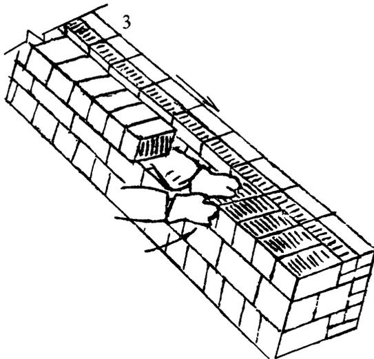
затем он плотно прижимает укладываемый камень к ранее уложенным (поз. 3) и осаживает его нажимом руки.
