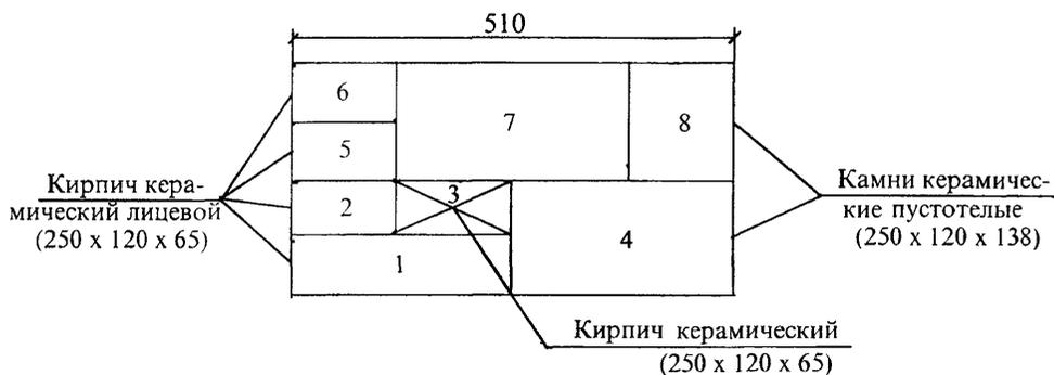
4.2 Операции по кладке армированных стен толщиной 51 см, с проемами, из пустотелых керамических камней с облицовкой керамическим кирпичом выполняются в следующем порядке:
