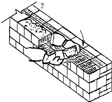
Каменщик К-2 подает раствор на стену под внутреннюю версту и на разложенные камни (поз 1).
