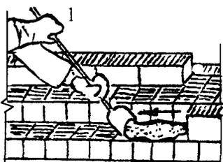
(поз. 1), левой рукой берет камень за боковые грани и подносит его к месту укладки, захватывает кельмой раствор с грядки и набрасывает его на тычковую грань камня (поз. 2). Затем опускает камень на постель, плотно прижимая его к ранее уложенному и осаживает нажимом руки (поз. 3).
