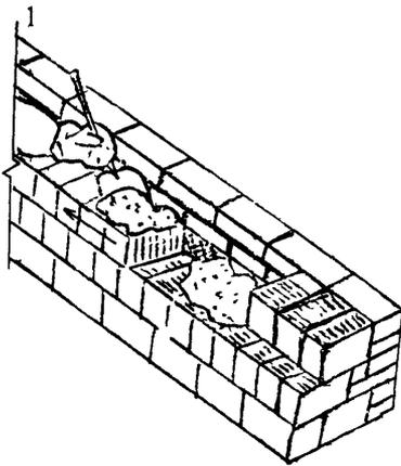
Каменщик К-1 разравнивает раствор кельмой, затем он берет обеими руками за торцовые грани камня и подносит его к месту укладки, постепенно поворачивая его так, чтобы его грань с раствором заняла вертикальное положение (поз. 2). Чтобы раствор не сползал, окончательный поворот камня каменщик К-1 осуществляет в момент осаживания камня на
