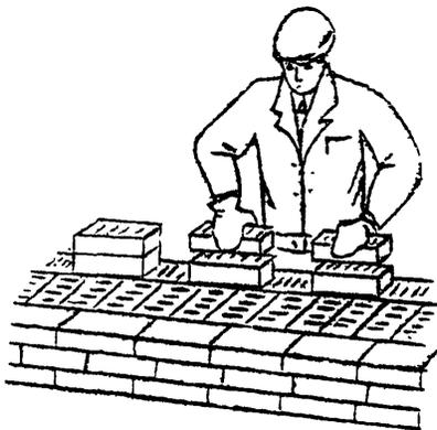
Каменщик К-2 выравнивает раствор, отступив от лица стены на 10 – 15 мм под ложковые ряды на ширину 70 – 80 мм через боковую грань лопаты, а под тычковые ряды — через ее передний край шириной 200 – 220 мм; растворную грядку выравнивает тыльной стороной лопаты.
