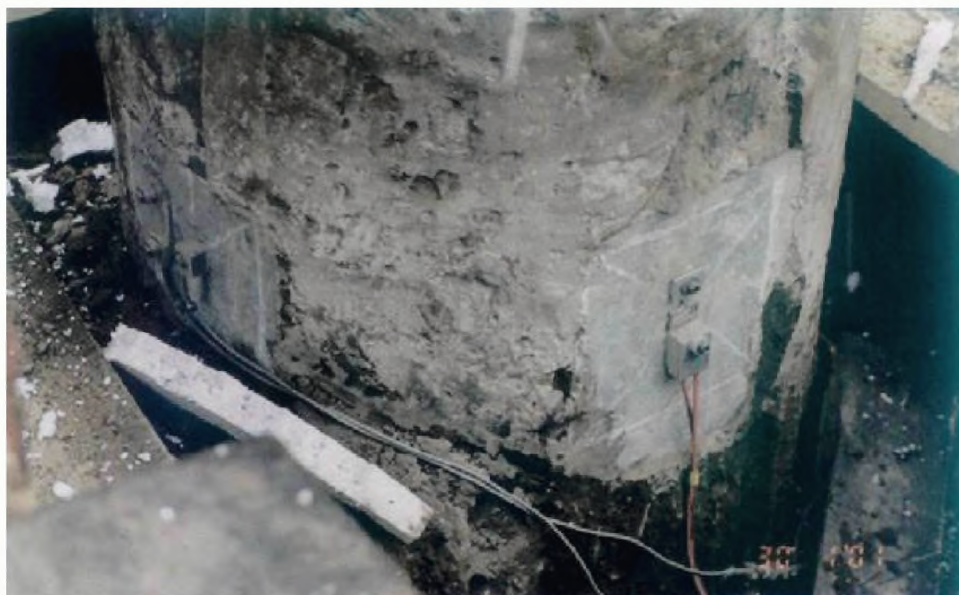
Рис.5. Нагружающее устройство и измерительные приборы для динамических испытаний по методу ЭЛДИ
