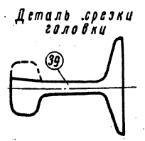
Деталь отгиба и срезки наружной половины головки контррельса при рельсах Р65 и Р75
