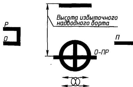
Рис. 14.4.3 Грузовая марка на судах класса «О-ПР» с избыточным надводным бортом
