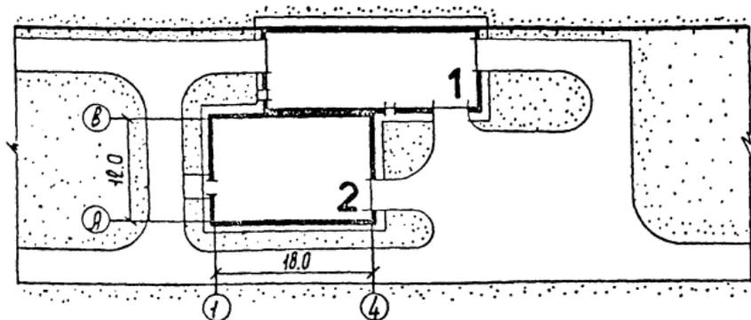
вариант отдельного здания очистных сооружений
