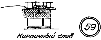
Карниз с жел. бет. плитой в бесчердачном здании с наружным отводом воды
