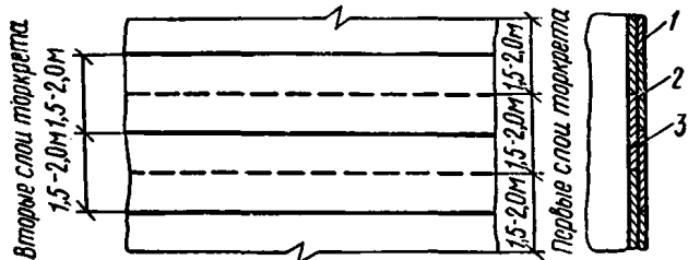
Рис. 105. Порядок нанесения слоев торкрет-гидроизоляции
