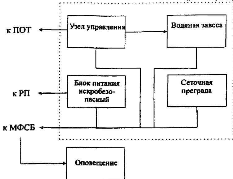
Рис. 1. Блок-схема подключения АВЗ: ПОТ — пожарно-оросительный трубопровод; РП — распределительный пункт электроснабжения; МФСБ — многофункциональная система безопасности
