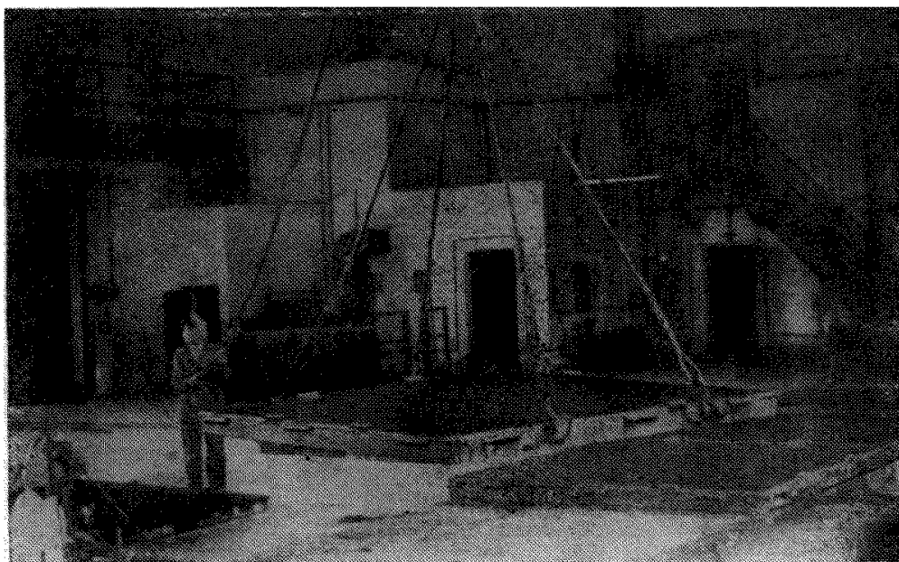
Рис. 3. Съем отформованных поддонов с конвейера кран-балкой
