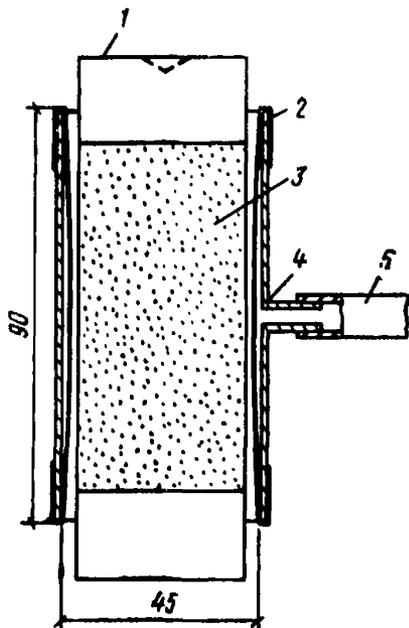
Рис. 11. Расширитель для образцов диаметром 38 мм
