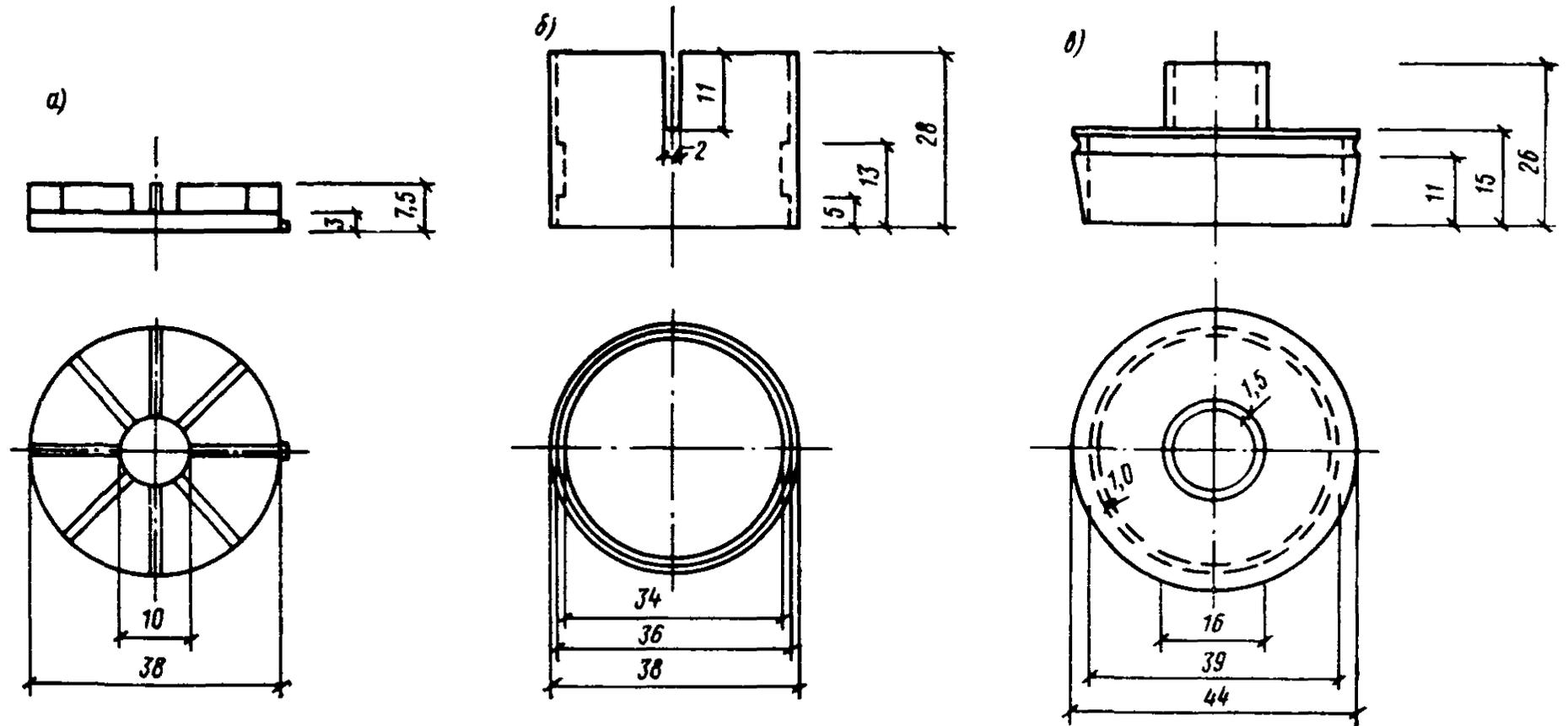
Рис. 10. Детали к прибору для определения прочности грунтов кручением под гидростатическим давлением
