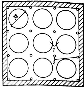
Рис. 26. Схема расположения в грунте песчаных дрен
