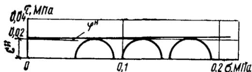
Рис. 15. Нормативные значения параметров прочности для нестабилизированного состояния мягкопластичной глины
