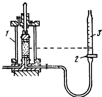
Рис. 8. Камера для трехосных испытаний с подключенным волюмометром
