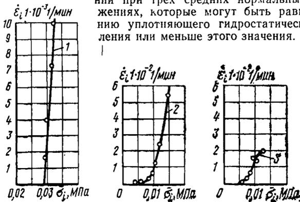
Рис. 24. Зависимость интенсивности касательных напряжений  $\bar{\sigma}_i$  на пределе разрушения от интенсивности скорости деформирования  $\dot{\epsilon}_i$
