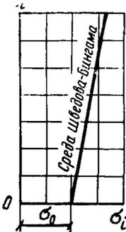
Рис. 18. Графическое изображение закона Шведова — Бингама
