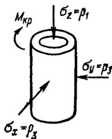
Рис. 2. Схема кручения пологого образца под гидростатическим давлением
