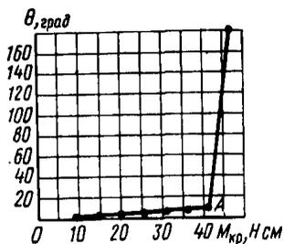
Рис. 17. График зависимости угла закручивания от крутящего момента
