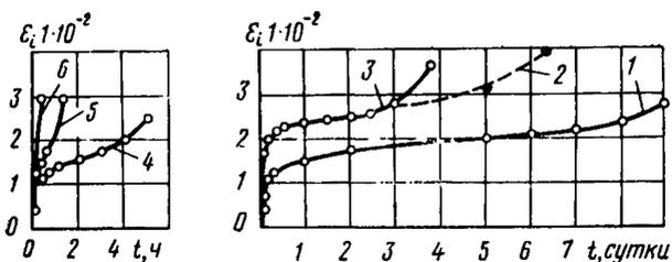
Рис. 22. Кривые ползучести в условиях кручения для уплотненного ила под гидростатическим давлением  $P_r = \sigma_{ср} = 0,025$  МПа
