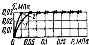
Рис. 30. График тарировки прибора на кручение
