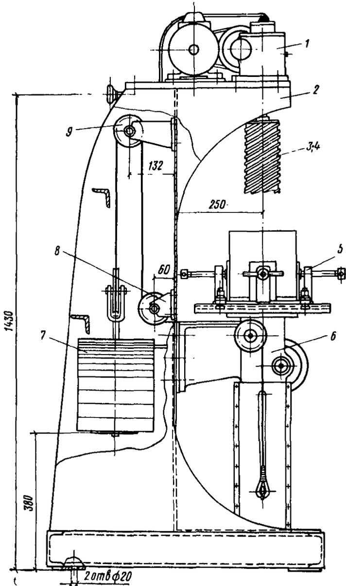
Рис. 27. Прибор для подготовки образцов из глинистых грунтов и торфа для испытания в стабилометре и кручением
