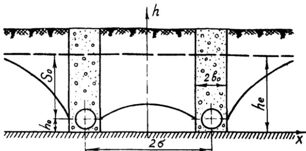
Рис.7. Схема к расчету двухлинейного
