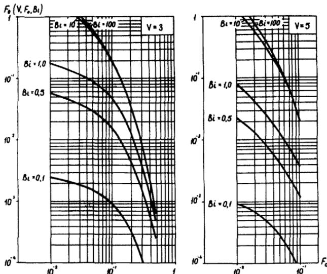
Рис. 18. График функции  $\bar{z}(v, f_0, B_i)$ .
