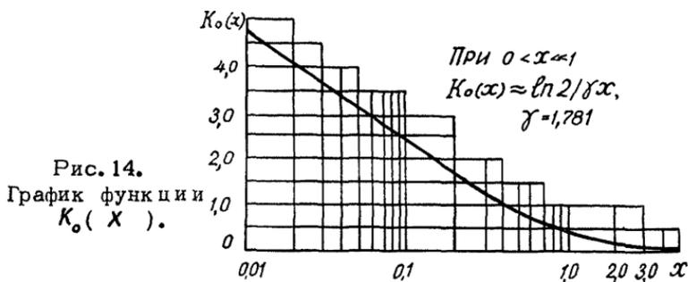
Рис. 14. График функции  $K_0(x)$ .
