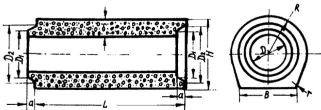
Рис. 1. Схема дренажного трубофилтра.
