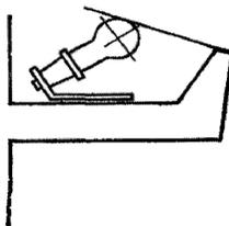
Рисунок 3.6 – Использование зеркальных ламп в световых карнизах
