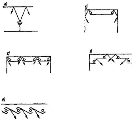
Рисунок 3.2 – Способы устройства отраженного освещения:
