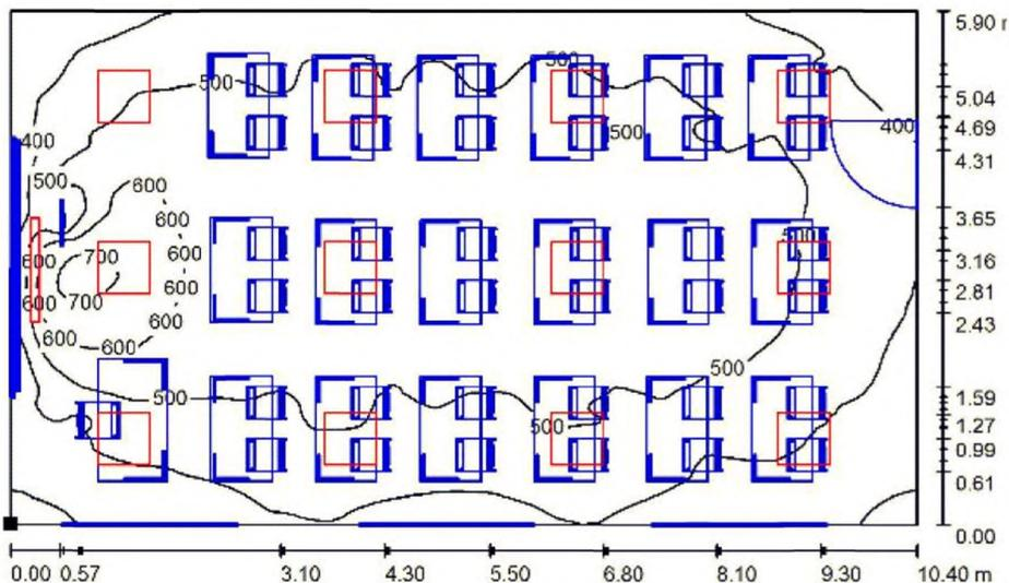
Рисунок 3.10 – Схема размещения светильников в классе
