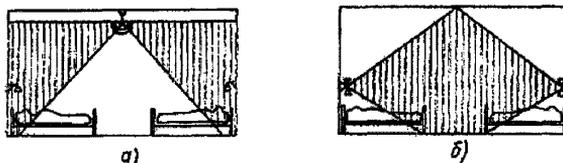
Рисунок 3.11 – Схема распределения света в палате лечебного учреждения:
