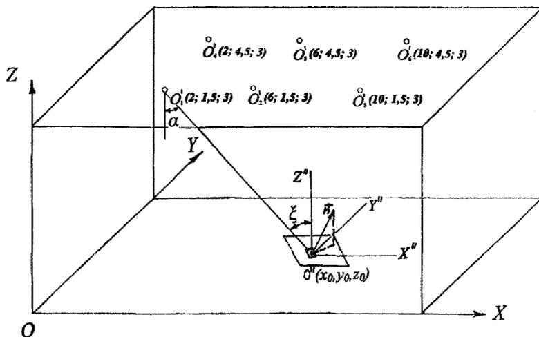
Рисунок 1.10 – К примеру расчета освещенности;  $O$  – светильник
