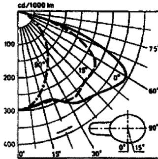
Рисунок 1.7 – Пример представления КСС несимметричного светильника в каталогах
