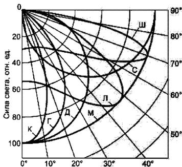
Рисунок 1.6 – Типовые кривые силы света по ГОСТ Р 54350
