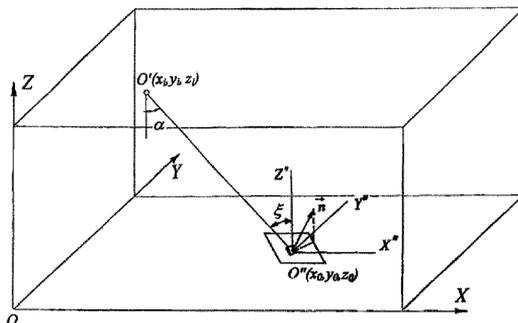
Рисунок 1.9 – Привязка помещения и светильников к осям координат
