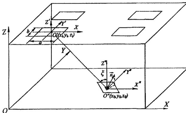
Рисунок 1.14 – К расчету освещенности от прямоугольного излучателя
