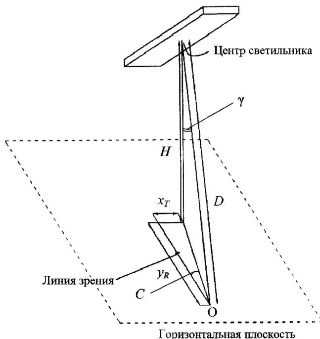
Рисунок 2.1 – Расположение центра светильника относительно работающего
