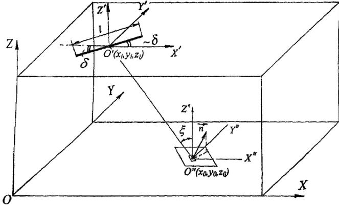
Рисунок 1.13 – К расчету освещенности от линейного излучателя
