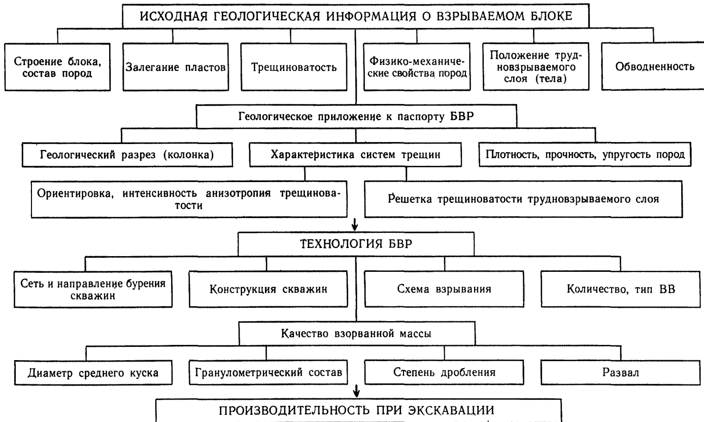
Рис. 37. Схема геологического обеспечения буровзрывных работ
