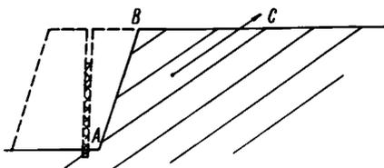
Рис. 2. Деформирование уступа при наличии наклонных подрезаемых трещин
