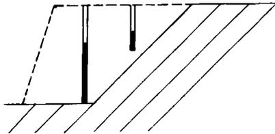
Рис. 9. Заоткоска уступа по наклонной трещине вертикальными зарядами
