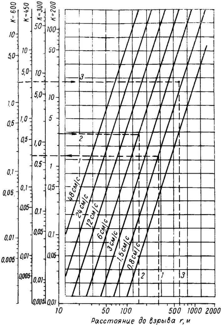
Рис. 10. Номограмма для определения сейсмобезопасных параметров взрывных работ:
