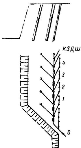
Рис. 5. Одновременное взрывание зарядов дробления и отрезной щели
