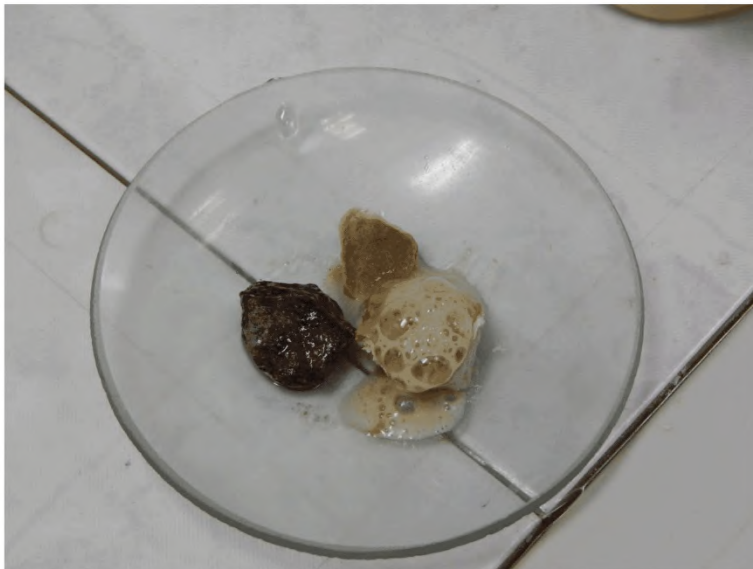
Фото 25 – Определение наличия карбонатных зерен в крупном заполнителе
