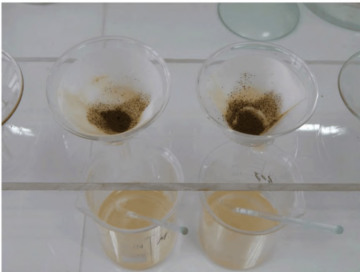
Фото 21 м Обработка растворной части бетона селективными растворителями
