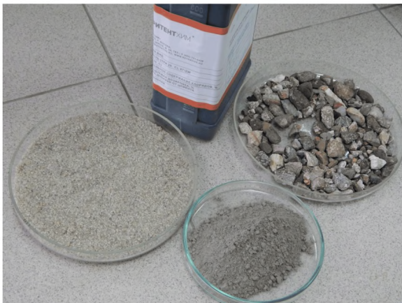
Фото 17 – Пример компонентов бетона
