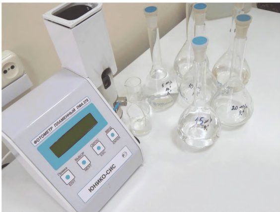
Фото 35 – Лабораторное оборудование. Пламенный фотометр
