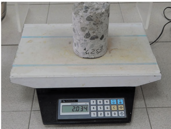
Фото 18 – Определение массы пробы керна
