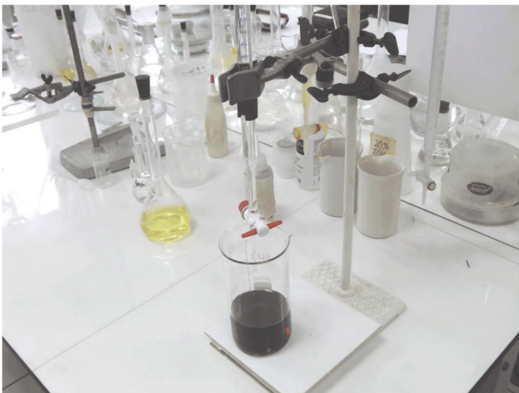
Фото 28 – Процесс титрования, определение основных оксидов
