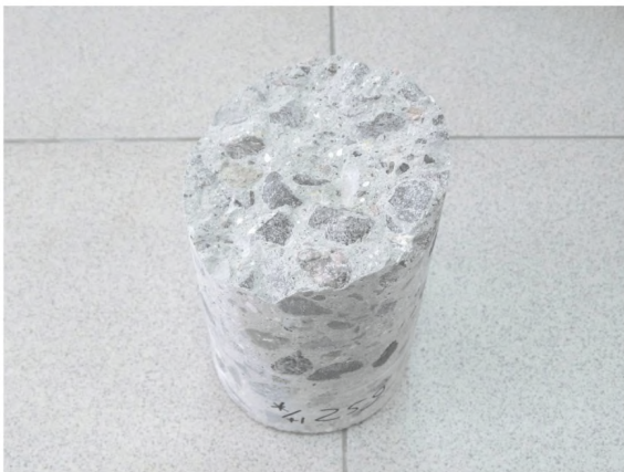
Фото 9 – Проба бетона – керн в лаборатории
