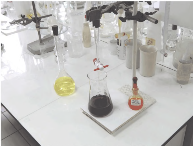
Фото 27 – Процесс титрования, определение основных оксидов
