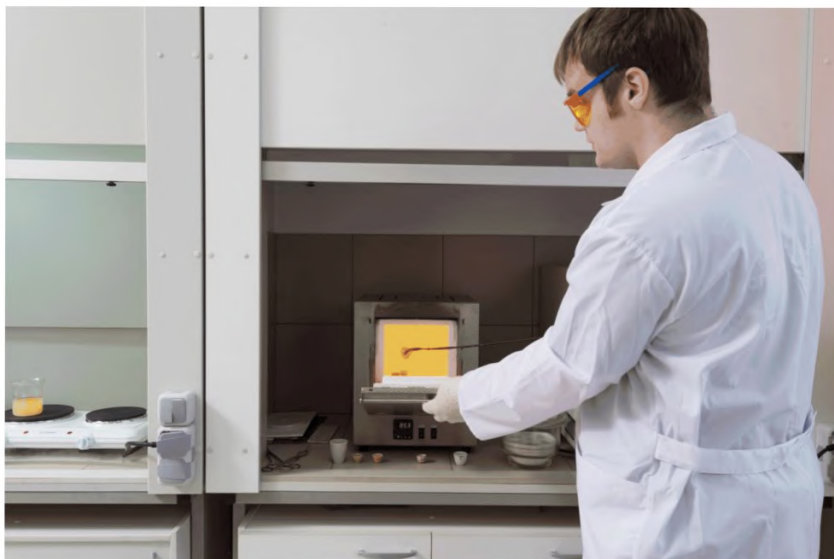
Фото 30 – Прокаливание тиглей с материалом
