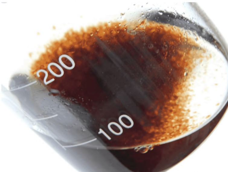
Фото 32 – Осаждение оксидов алюминия и железа
