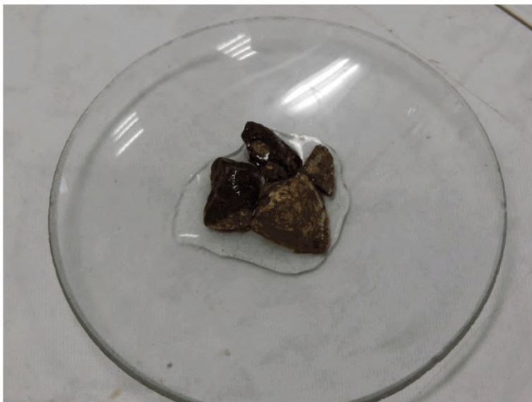
Фото 26 – Определение наличия карбонатных зерен в крупном заполнителе
