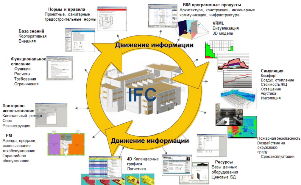
Рисунок 4.2 – Схема обмена данными на основе IFC на всех стадиях жизненного цикла зданий и сооружений [12]
