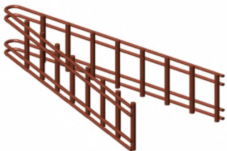
Рисунок 3.2 – Изогнутый каркас для предотвращения продавливания плит
