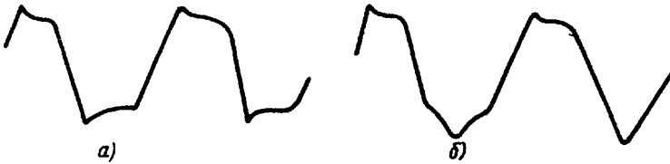
Рис. 6. Форма кривой напряжения на стабилизаторах органа управления:
