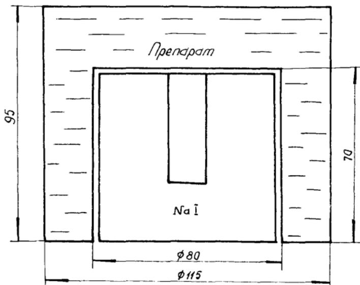
Рис.1. Геометрия измерения препаратов. Вариант "а" -
