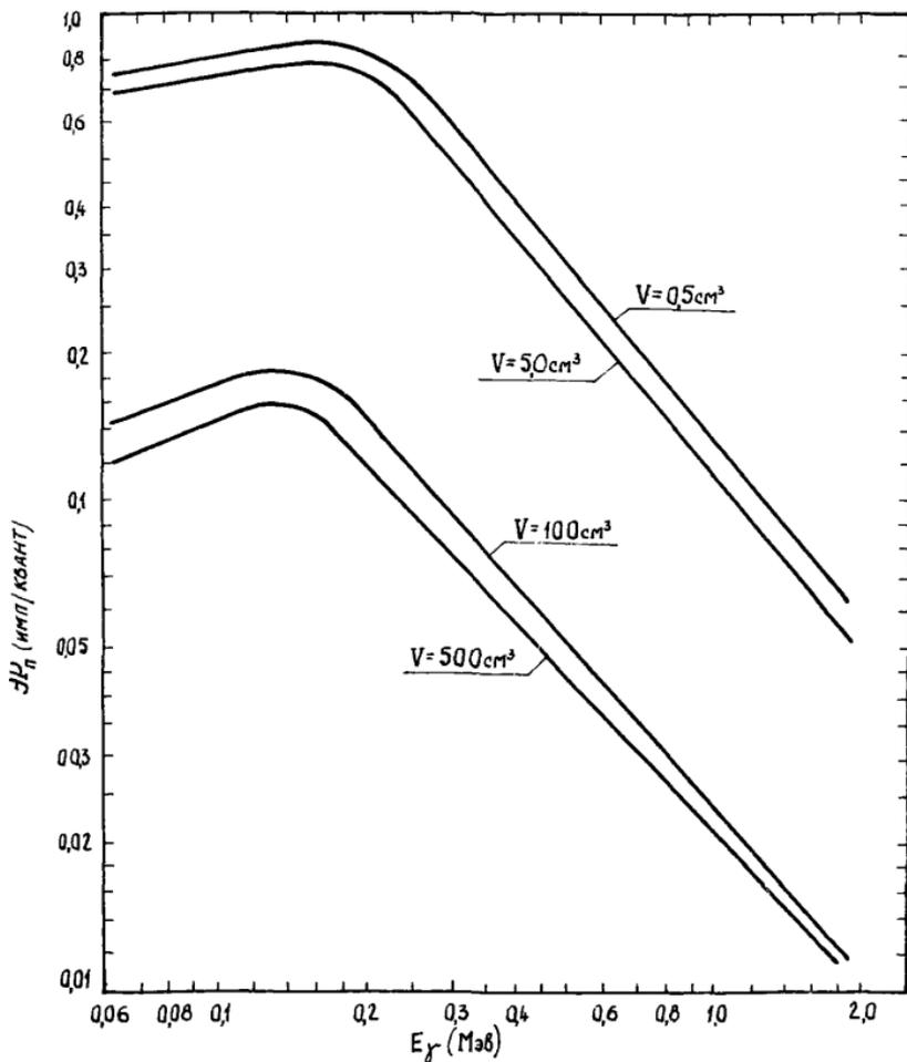
**Рис.3.** Зависимость эффективности регистрации ЭР (при измерениях по пику полного поглощения) от энергии  $E_\gamma$  гамма-излучения
