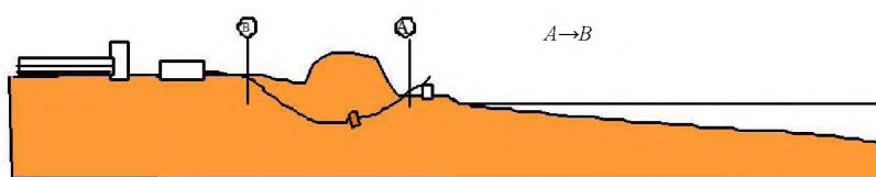
1. ННБ со стороны пляжа с разработкой траншеи в прибрежной зоне
