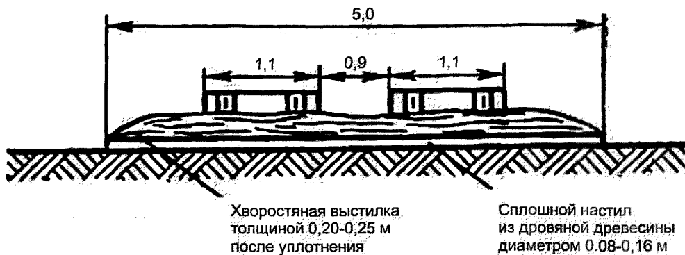
Рисунок Г3 – Поперечный профиль лесных дорог на болотах II типа при толщине торфа до 2м.
