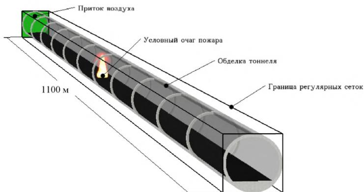
**Рисунок 5.2 – Модель полуперегона тоннеля**
