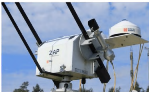
Рисунок 10 – Размещение на следящей системе пиргелиометра (слева), пиранометров и пиргеометра (справа)
