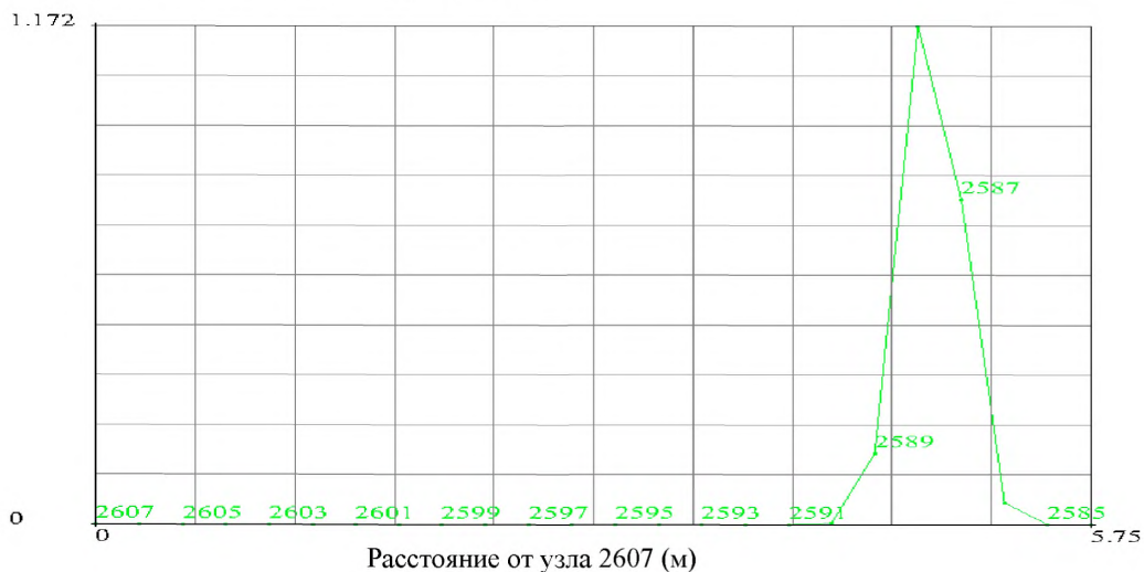
Рисунок 5 – График распределения эквивалентных пластических деформаций в упруго-пластическом основании в вертикальном сечении между узлами 2585 и 2607 (рисунок 1) при нагрузке, приложенной в середине длинного края плиты.
