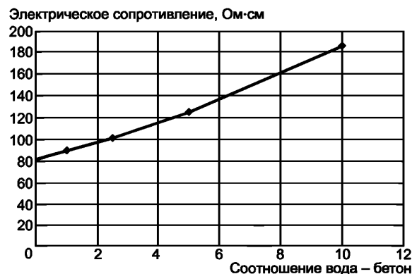
Рисунок 4 — Оценка электрического сопротивления водной вытяжки из бетона
