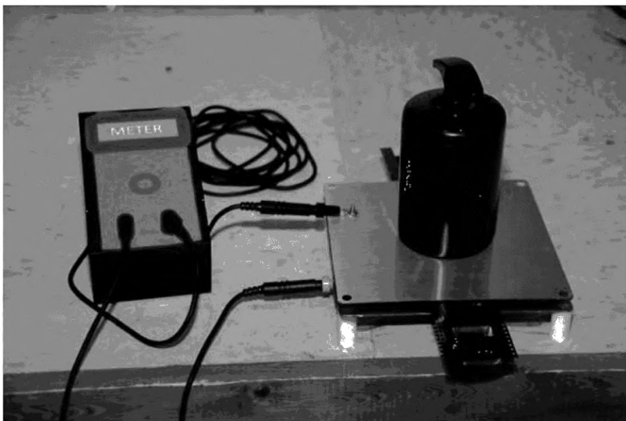
Рисунок 7 — Установка для испытания методом параллельных пластин
