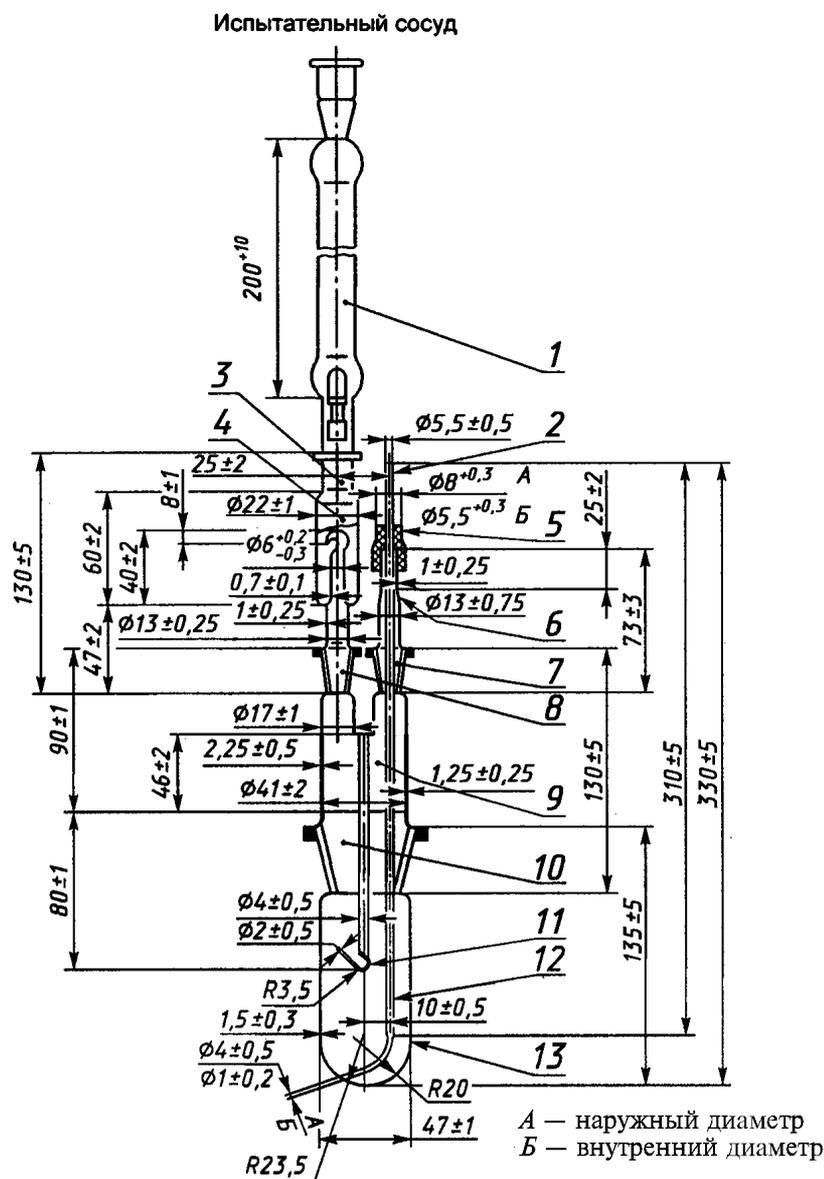
1 — холодильник со шлифом 14/23; 2 — трубка для подвода газа с толщиной стенки  $0,75 \pm 0,25$ ; 3 — ловушка для конденсата; 4 — гильза со шлифом 14/23; 5 — шланговое соединение; 6 — переходная трубка; 7 — шлиф 14/23; 8 — гильза со шлифом 14/23; 9 — гильза со шлифом 45/40; 10 — гильза со шлифом 45/40; 11 — крючок для подвешивания катализатора; 12 — капилляр; 13 — пробирка
