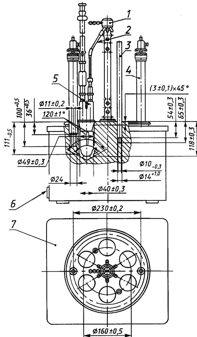
1 — распределитель; 2 — капилляр; 3 — контрольный термометр; 4 — контактный термометр;
