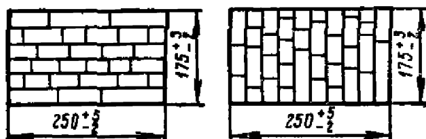
Рис. 30. Конструкция и размеры поперечных сечений клееных переводных брусев
