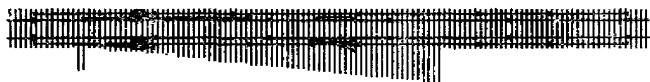
Рис. 63. Заготовка плетей стрелочного перевода для укладки в путь по уложенным брусьям в промежутки между поездами
