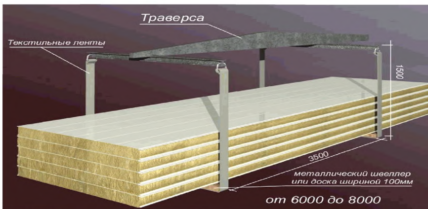
Рисунок 9 – Схема строповки пакетов панелей длиной от 6000 мм до 8000 мм
